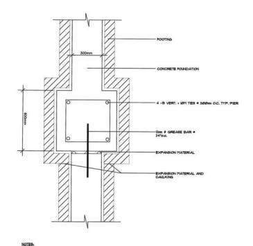
L EXPANSION JOINTS OCCUR ON ONE SIDE OF A PIER AT 8,893M TYP
